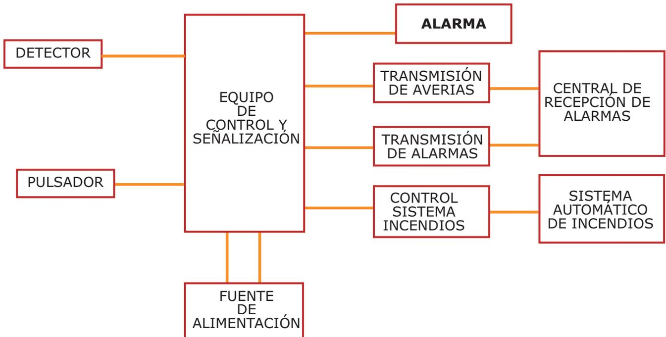
**1. Detector:** Es un dispositivo que contiene un sensor que controla de forma continua o a intervalos un fenómeno físico o químico correspondiente a un incendio y que emite una señal. Se utiliza para poder percibir un fuego en un lugar poco frecuentado por personas o en el interior de un equipo de trabajo.
